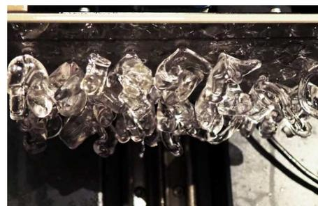
Nous utilisons depuis plus de 12 ans la technologie d'impression 3D pour fabriquer les embouts et protections auditives sur mesure. Cette technique de production apporte fiabilité et grande précision de fabrication.
